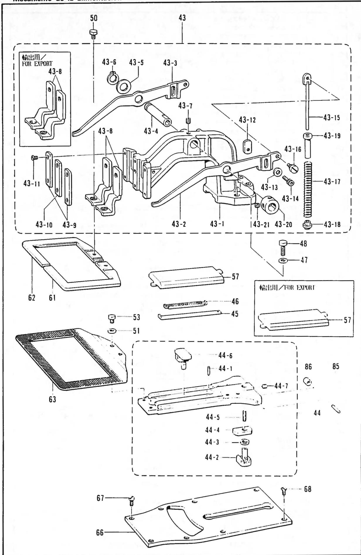
D. 送り関係/Feed mechanism/Transportvorrichtung/Mécanisme de l'entraînement/
