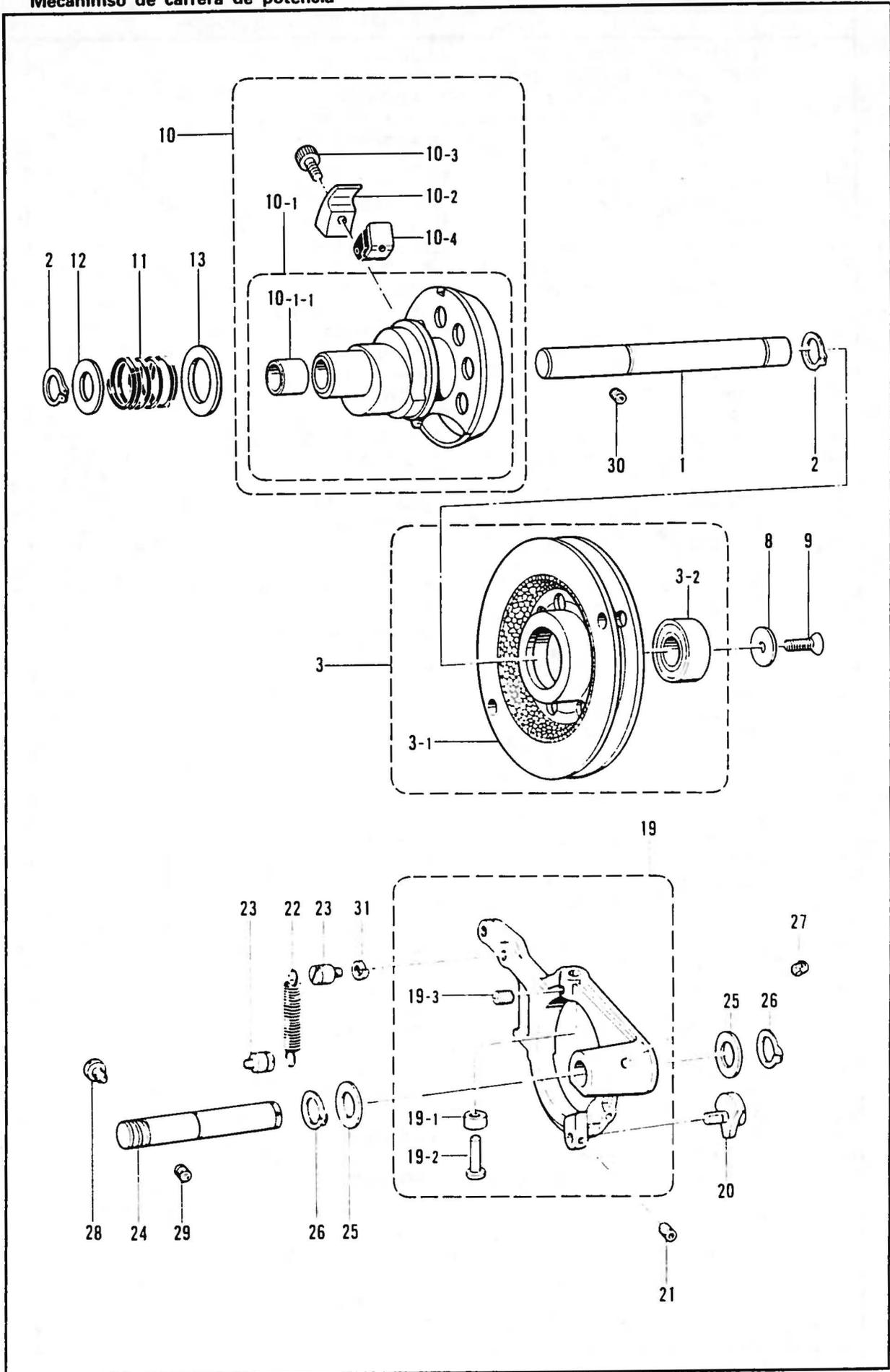
G. パワー押工関係/Power lift mechanism/Heberbetätigungsvorrichtung/Mécanisme de leueur/
