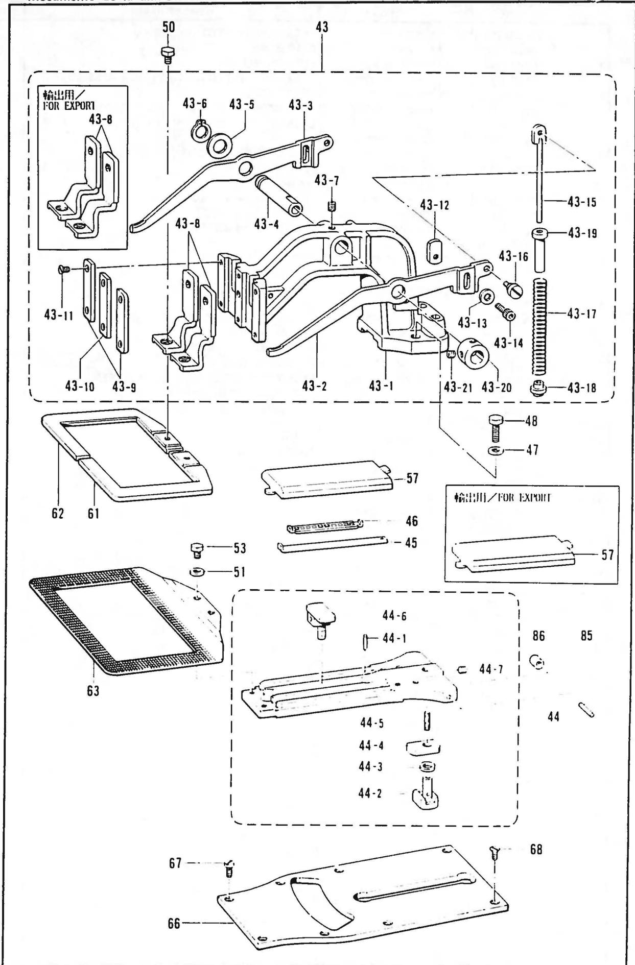
D. 送り関係/Feed mechanism/Transportvorrichtung/Mécanisme de l'entraînement/
