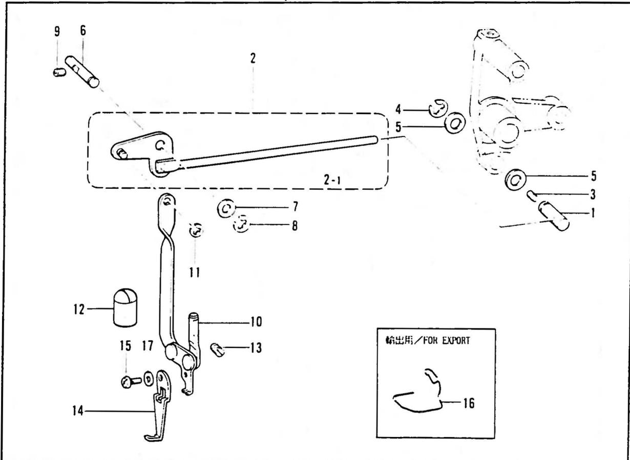
P. 糸締メ関係 / Thread nipper mechanism / Fadenspannvorrichtung / Mécanisme de pince-fil / Mecanismo de la mordaza para hilo
