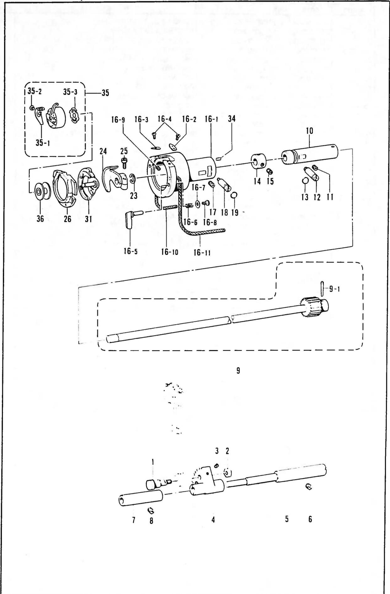
H. 下軸関係/Lower shaft mechanism/Untere Welle/Mécanisme de l'arbre inférieur/
