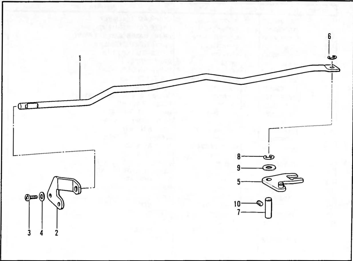
Q. 糸払い関係 / Thread wiper mechanism / Fadenwischvorrichtung / Mécanisme de tire-fil / Mecanismo del limpiador de hilo
