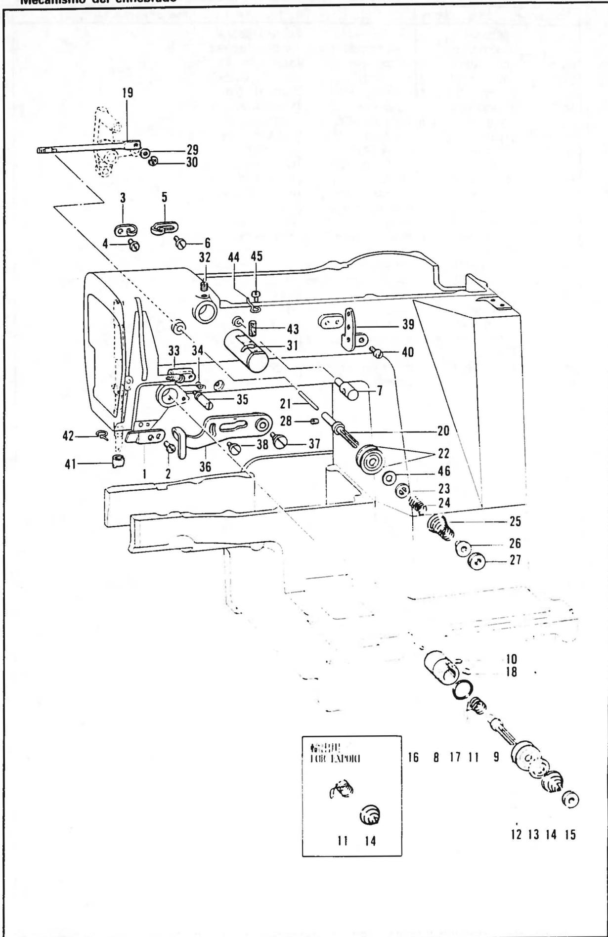
K. 糸通シ関係 / Threading mechanism / Fadenführungsrichtung / Mécanisme de l'enfilage / Mecanismo del enhebrado
