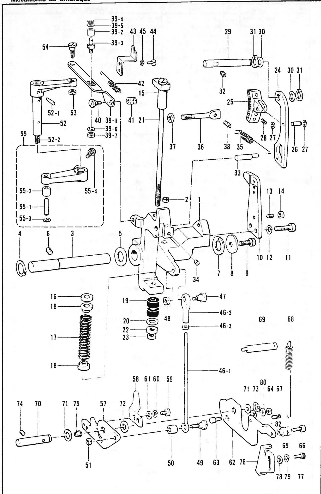
B. クラッチ関係 / Clutch mechanism / Kupplungsvorrichtung / Mécanisme de l'embrayage /
