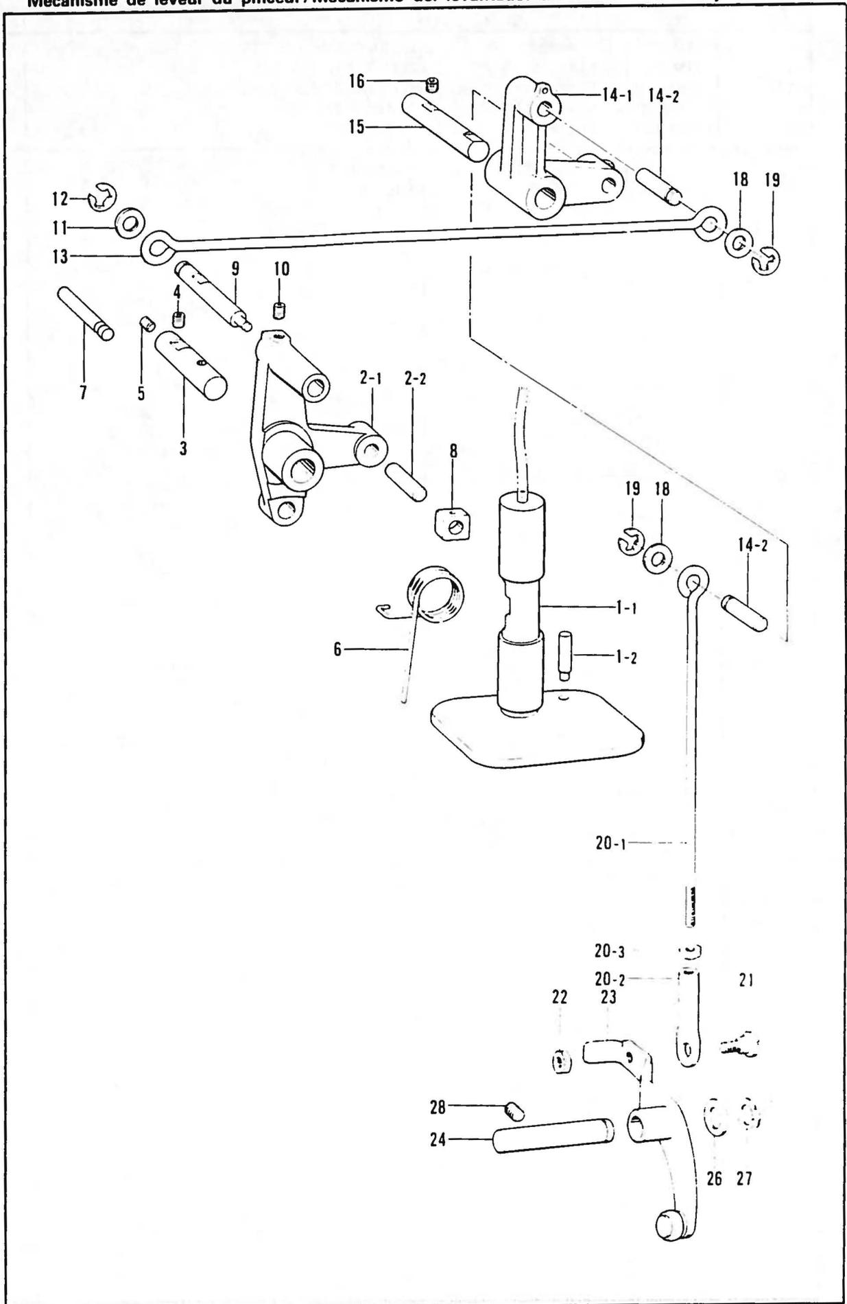
E. 押工上ケ関係/Work clamp lifter mechanism/Stoffhalterhebevorrichtung/
