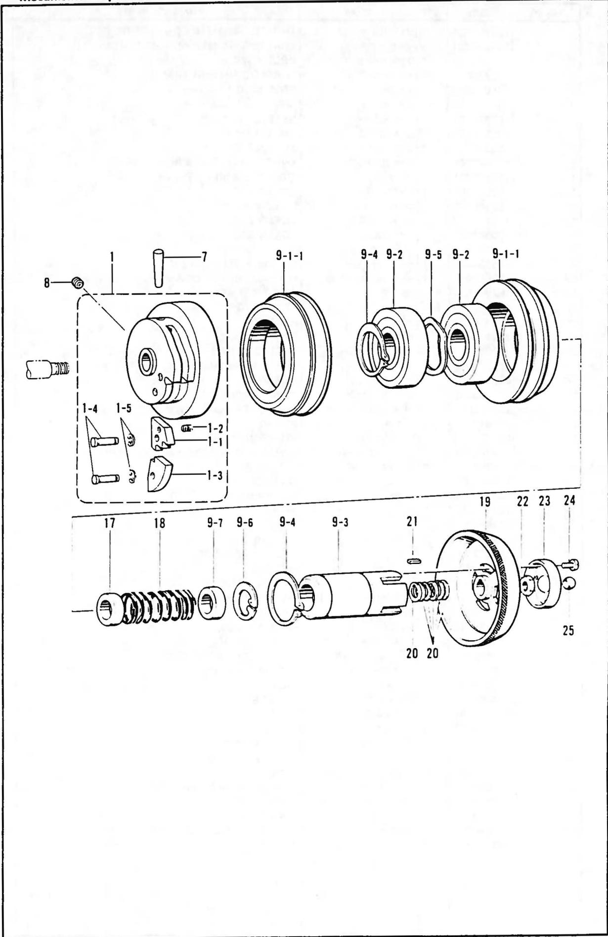
N. 動車、遊車関係/Drive pulley and idler pulley mechanism/Antriebsriemenscheibe und riemenscheibe/
