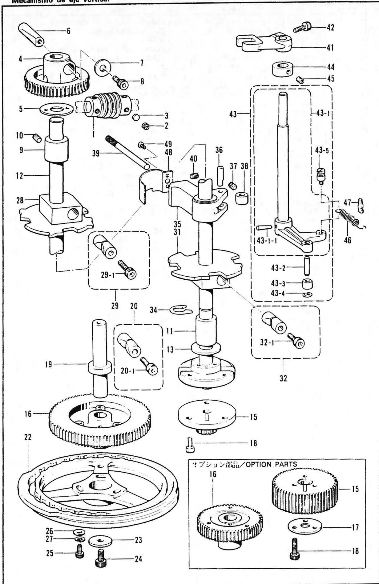
F. カム・伝導関係 / Vertical shaft mechanism / Vertikale Welle / Mécanisme d'arbre vertical / Mecanismo de eje vertical
