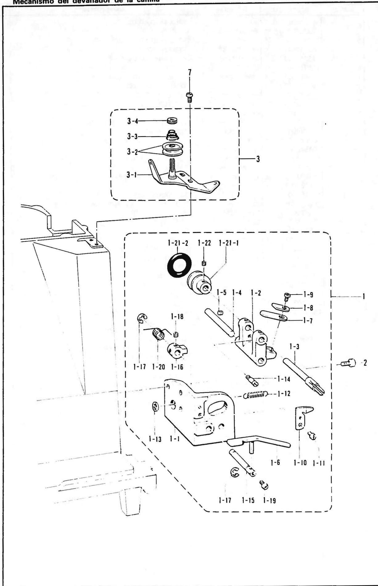
L. 糸巻装置関係 / Bobbin winder mechanism / Spuler / Mécanisme du bobineur /
