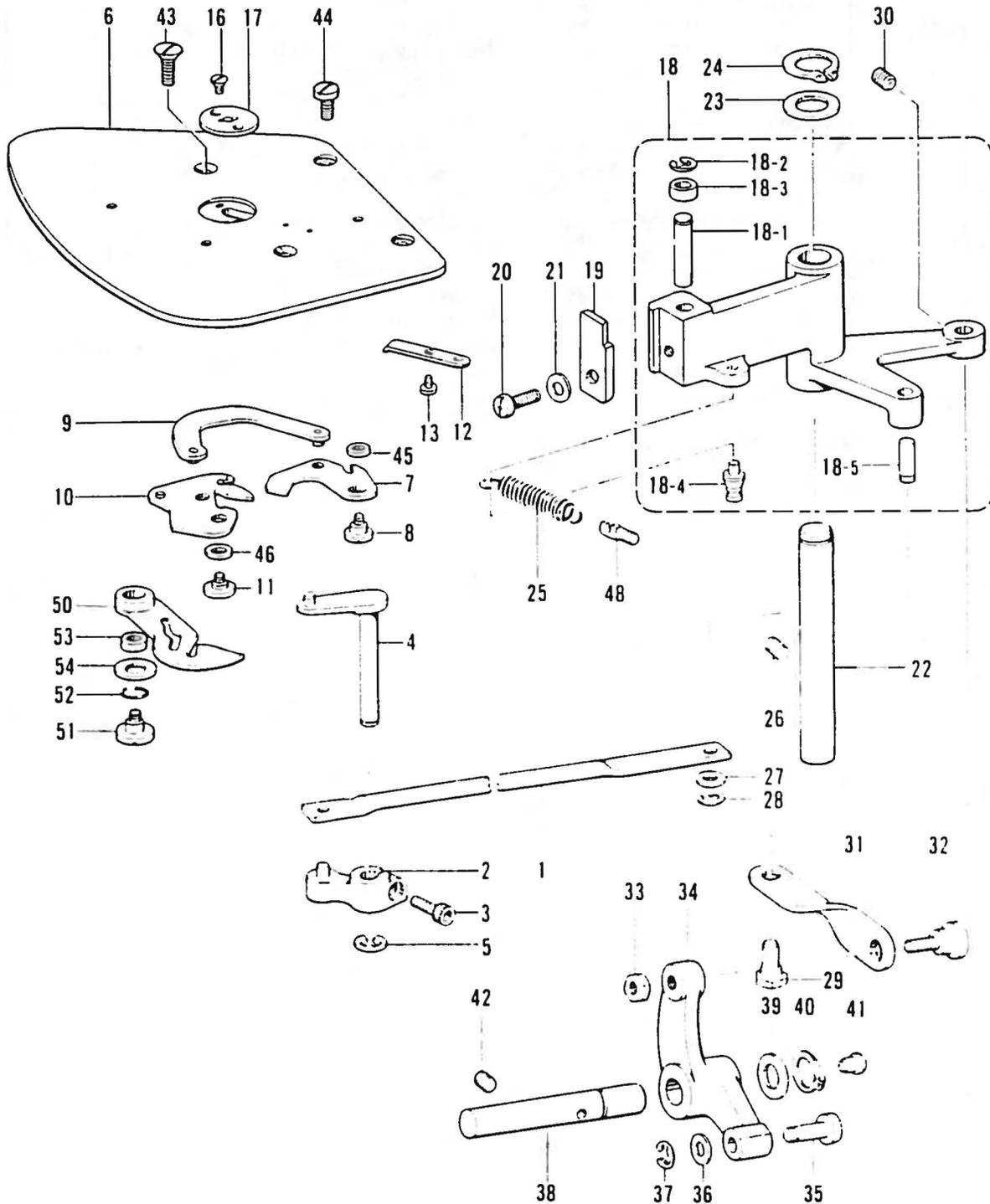
M. 糸切り関係/Thread trimmer mechanism/Fadenabschneidevorrichtung/
