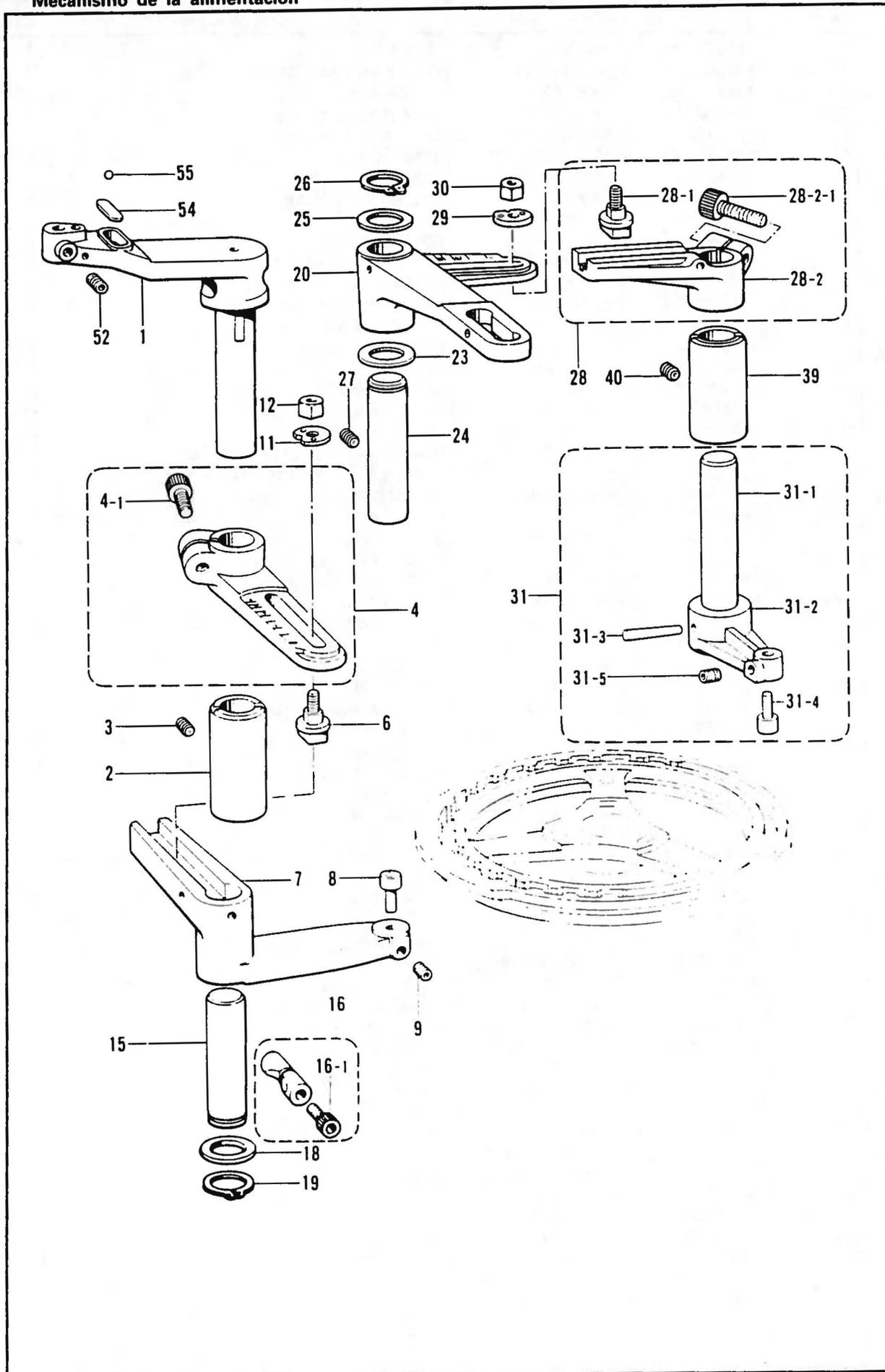
D. 送り関係 / Feed mechanism / Transportvorrichtung / Mécanisme de l'entraînement / Mecanismo de la alimentación
